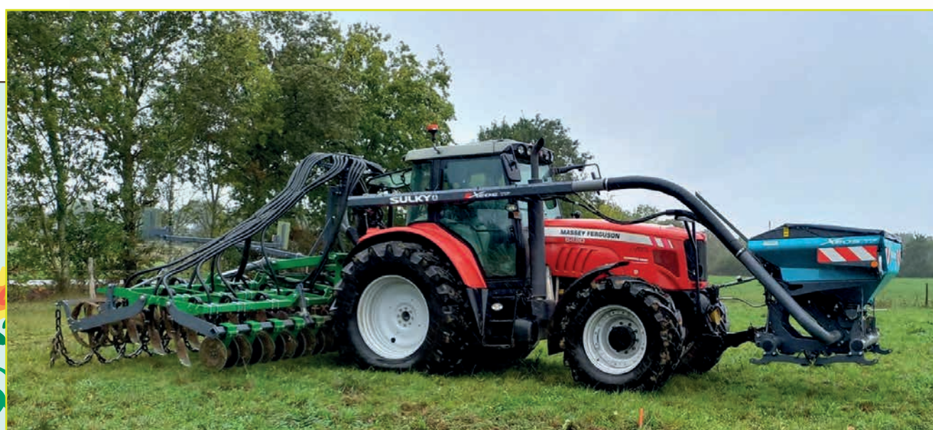
Semoir SIMTECH (Aitchinson) pour semis direct de dérobées dans les prairies, et semis des céréales.
