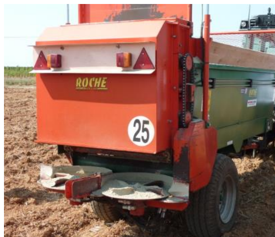
Le calcaire grossier et les composts jeunes de fumiers peuvent être épandus avec un épandeur à plateaux
