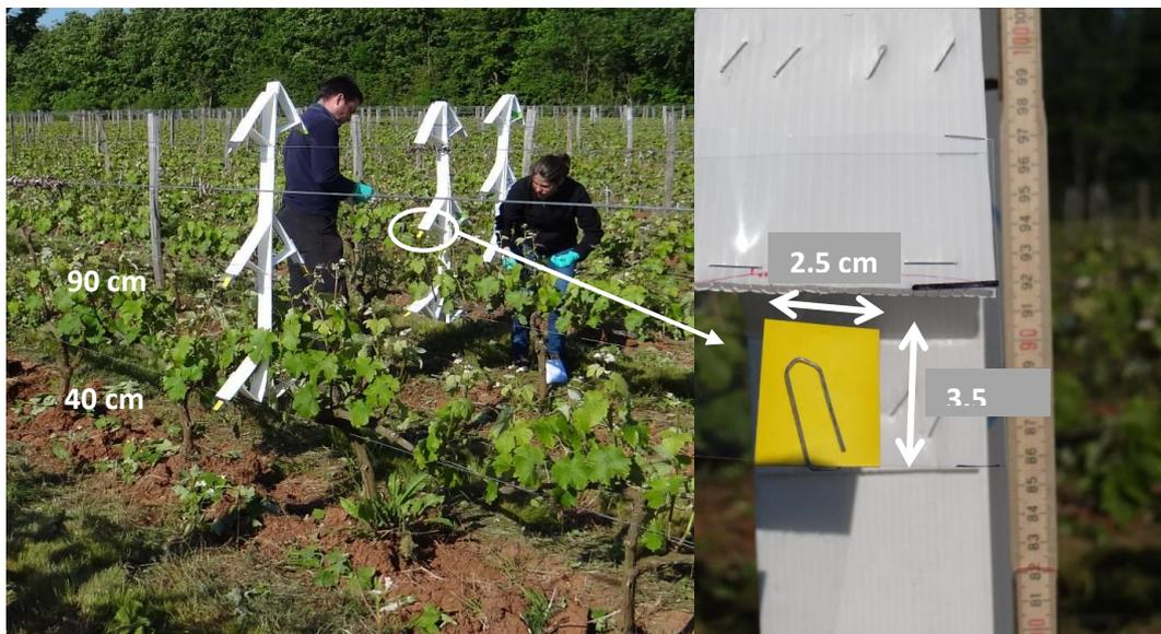
Après passage du pulvérisateur avec de l'eau, les papiers sont ramassés, dépliés et collés sur une feuille (image ci-dessous) : une moitié simule la face supérieure de la feuille, et l'autre moitié simule la face inférieure.
